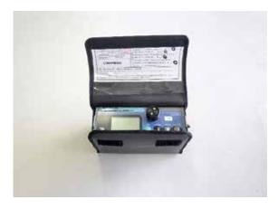
(7) 二酸化窒素/(8) 揮発性有機化合物 検知管をサンプリングポンプで吸引し測定
