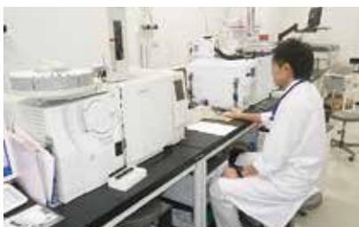
抽出した検体（抽出液試料）を、ガスクロマトグラフ質量分析計にセットして測定していきます。測定が終了したら、測定対象物質のヘキサンの有無やその濃度についてデータを解析します。次に、これらの結果を基に、当該作業場の作業環境評価を行います。
