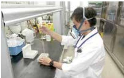
サンプリング後の捕集管内の活性炭をバイアル瓶に移し、抽出液を注入します。これで、測定対象物質であるヘキサンが抽出液に移されました。つまり、測定対象物質（今回はヘキサン）の抽出が完了しました。
