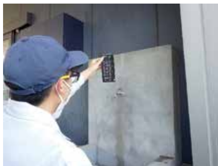
▲浄水の残留塩素濃度測定の様子
